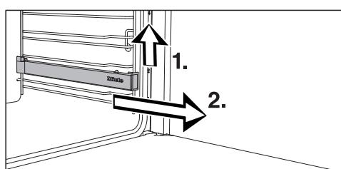
■ Приподнимите направляющую FlexiClip спереди (1.) и извлеките её вдоль опоры уровня (2.).
